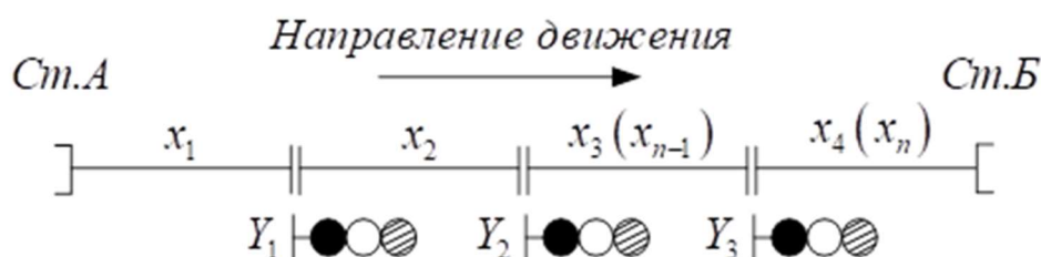
Рисунок 1. Условно-графическое обозначение перегона между двумя станциями
