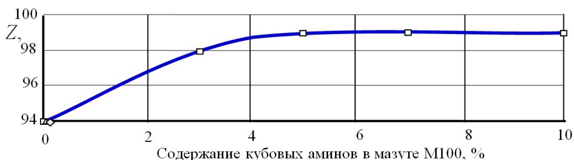
Рисунок 3. Изменение степени защиты Z покрытий на основе мазута М100 в зависимости от содержания кубовых аминов
