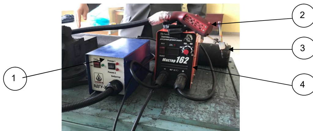
1 - блок управления; 2 – вибратор с креплением для электрода; 3 – графитовый электрод; 4- инвертор сварочный
