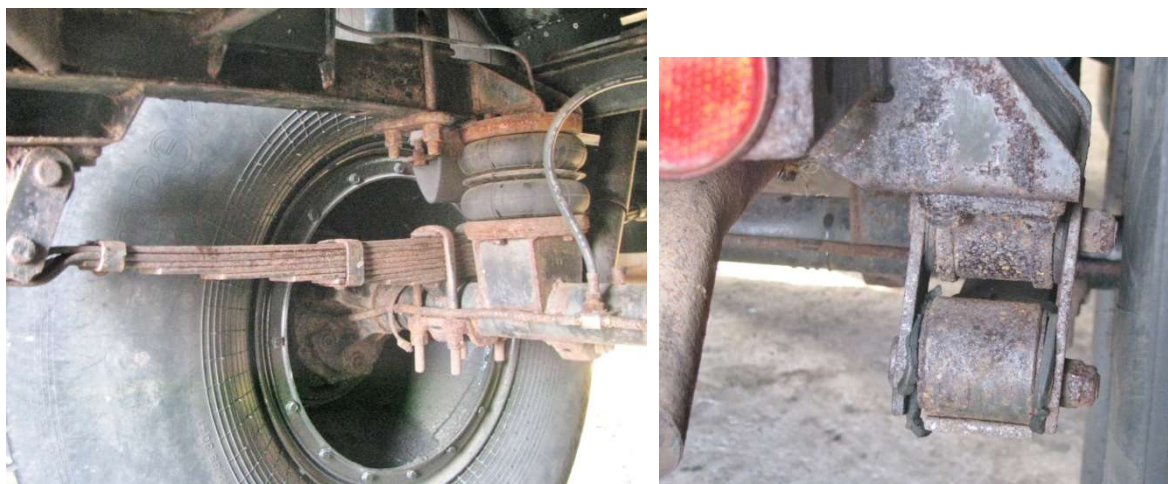
Рисунок 2. Очаги коррозионных разрушений на раме и подвеске базового автомобиля УАЗ-469 машины Amazone ZA-M900 после 2-х лет эксплуатации
