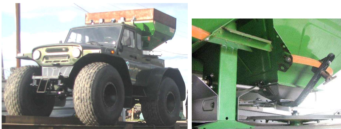
Рисунок 1. Состояние противокоррозионной защиты облицовки автомобиля УАЗ-469, бункера и тукоразбрасывающего механизма на машине Amazone ZA-M900
